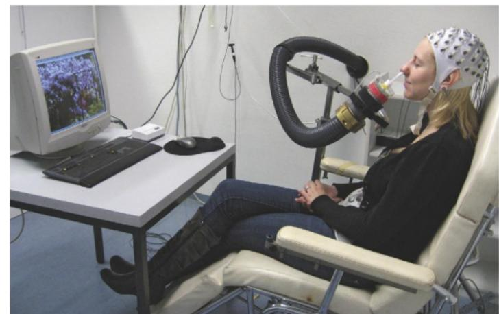
Oben: In einem Gaschromatografen werden Geruchsgeber (etwa ätherisches Öl) in ihre Inhaltstoffe getrennt. Unten: Ein Olfaktometer leitet bestimmte Gerüche an die Nase weiter. Ein EEG-Gerät misst die Gehirnaktivität.
